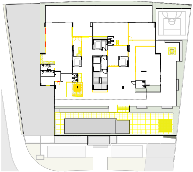
MCP PLANTA - DEMOLIR
